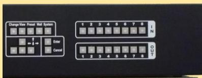
出力映像の切替は、フロントボタンにより簡単に選択することが可能です。また、RS-232C、LANポートを持ち、操作パネルからの外部制御も可能です。
